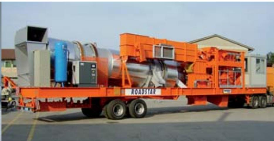
Les centrales mobiles discontinues trouvent leur intérêt lorsque la production doit être réalisée à proximité immédiate du chantier d'application, et lorsque les enrobés doivent respecter des critères stricts de qualité, notamment en termes de granulométrie.
